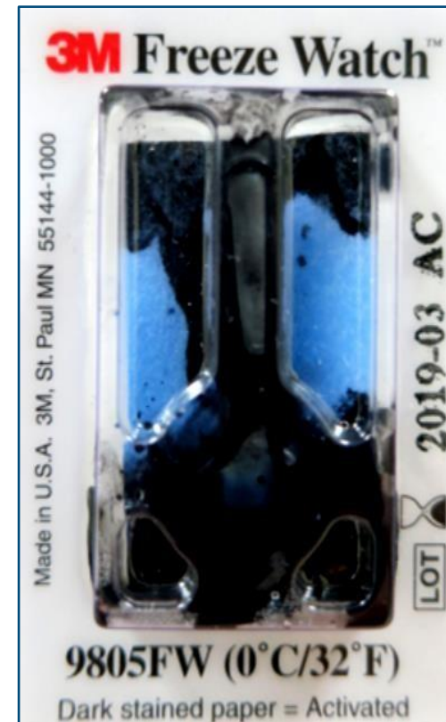
破裂的冷凍片
